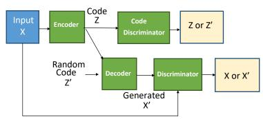
AI 自動認識 & 良否判定システムでは、入力画像と、 Decoderが生成した鮮明な疑似画像を比較・解析して 異常を検出する方式を採用。
